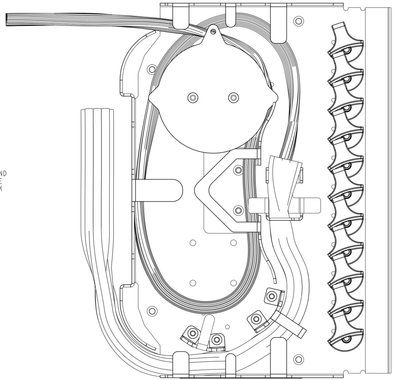
\* ROUTE ALL FIBERS AROUND SPOOL AND OUT THE SIDE AS SHOWN. (LEAVE SLACK LOOP LONG)
