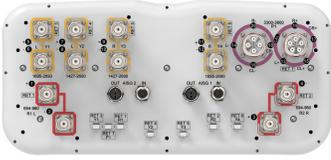
20-port sector antenna, 4x 694-960, 4x 1427-2690, 4x 1695-2690 MHz, 65° HPBW and 8x 3300-3800 MHz, 90° HPBW, 7x RET.
